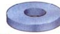
Магнет у облику прстена има један пол на горњој површини а други на доњој.
